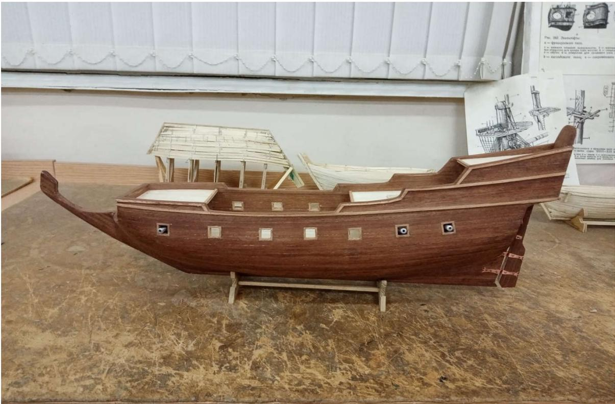
При помощи шпона из красного дерева и клея придаю кораблю благородный вид. После того как корабль снят со стапеля делаю палубы и клеиваю, затем внутренний борт. Из брусков бука изготовим и клеим бархоуты, а также из досок, того же материала, изготовил пушечные порты. Перилла, как и борт судна, из красного дерева. Изготавливаю руль, румпель, петли и устанавливаю на корабль.
