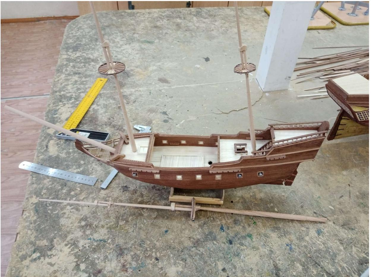
На токарном станке изготавливаю фок, грот, бизань и бушприт мачты, а также стеньги и бом-стеньги, на каждую мачту, где нужно. Сделал марс площадки. Собрал и установил мачты.
