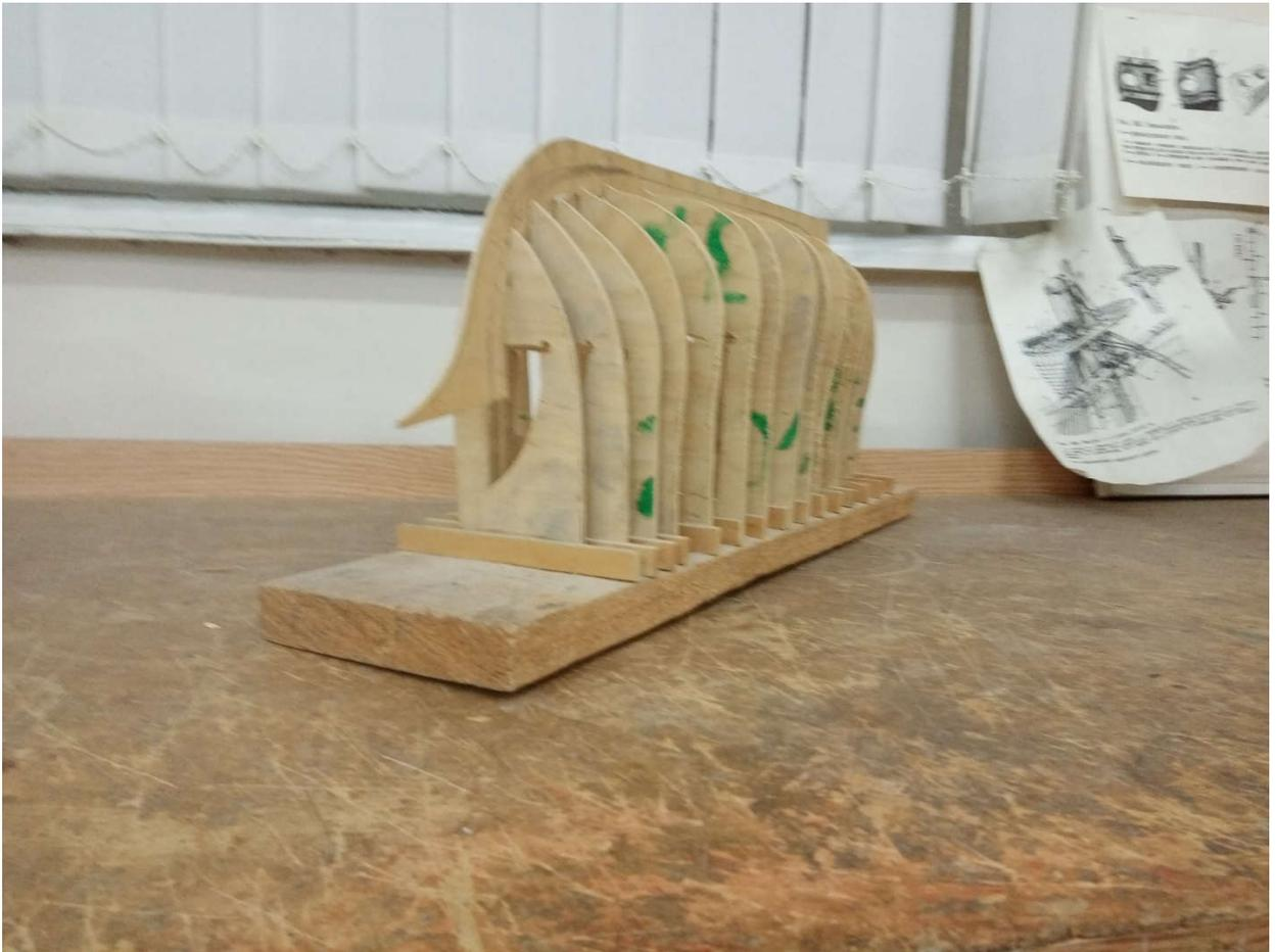
Теперь приступаю к изготовлению корпуса. Переношу с чертежа на фанеру шпангоуты, килевую раму и выпиливаю на электролобзике. Затем устанавливаю выпиленные детали на стапельную доску.
